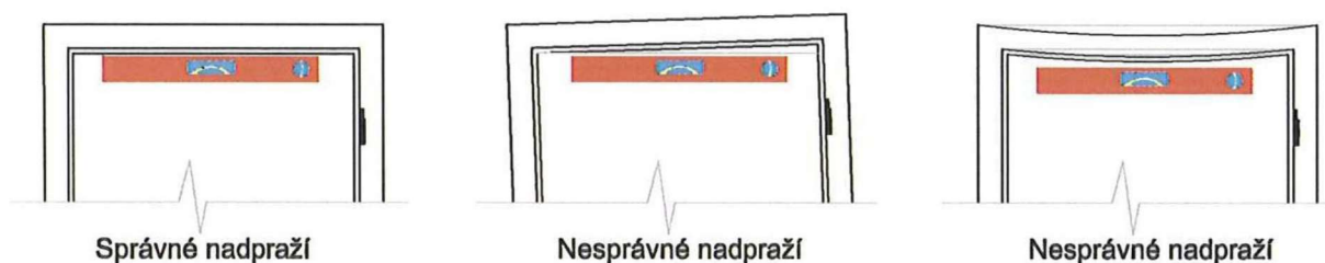
Obrázek 9. - Ukázka správného a nesprávného usazení zárubně.
