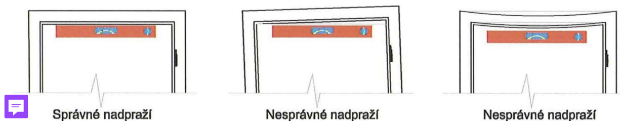
Obrázek 6. - Ukázka správného a nesprávného usazení zárubně.
