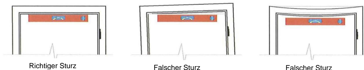
Abbildung 6. - Demonstration des richtigen und falschen Einbaus der Zarge.
