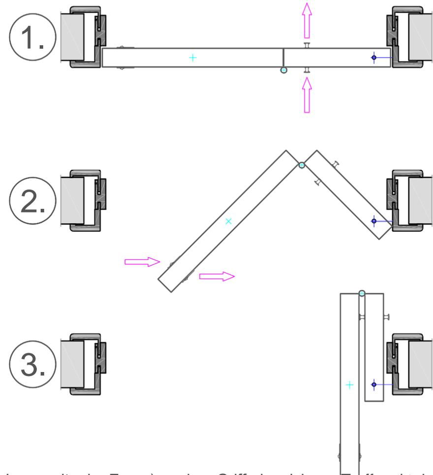
1. Drücken Sie (von der Außenseite der Zarge) oder ziehen Sie (von der Innenseite der Zarge) an dem Griff, der sich am Treffpunkt der Lamellen befindet.
