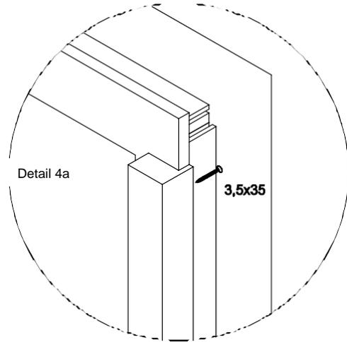
Befestigung der Abstandsleiste mit Zarge - B, D, F, H
