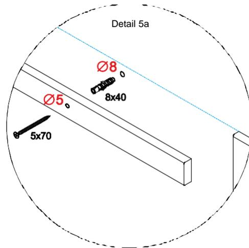
Befestigung der Schiene mit Zarge – B, D, F, H
