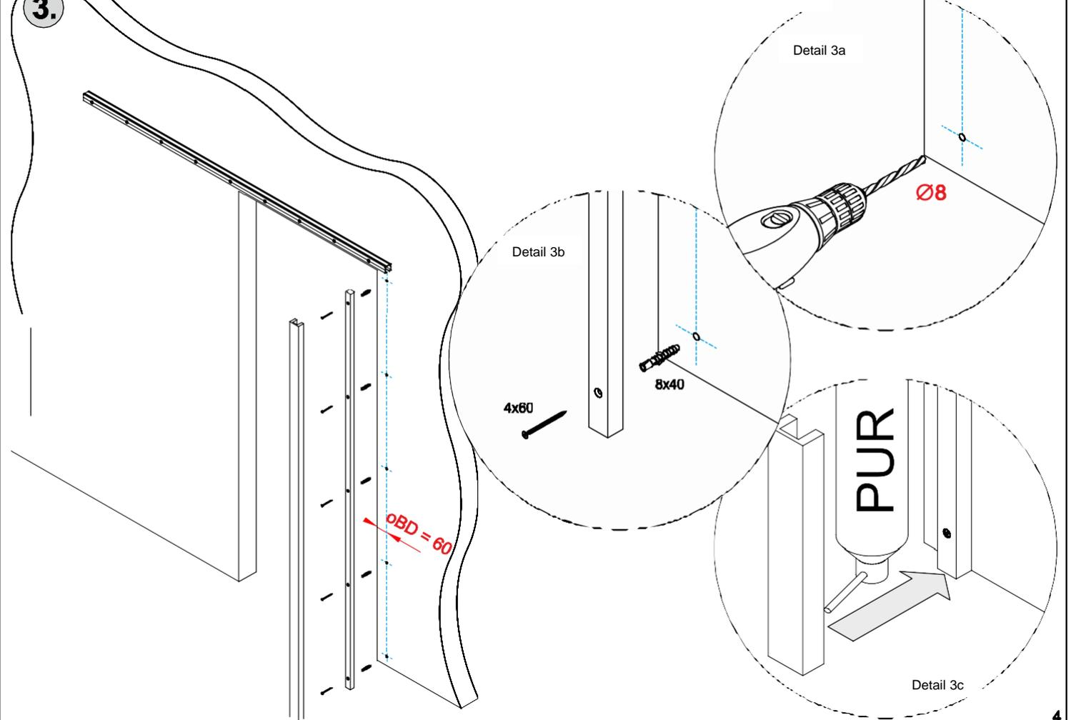
Befestigung des Seitenanschlags mit Zarge - D, H
