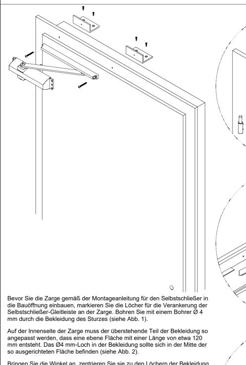
Bringen Sie die Winkel an, zentrieren Sie sie zu den Löchern der Bekleidung und schrauben Sie sie mit 4 x 19 Schrauben an das Futter (siehe Abb. 3).
