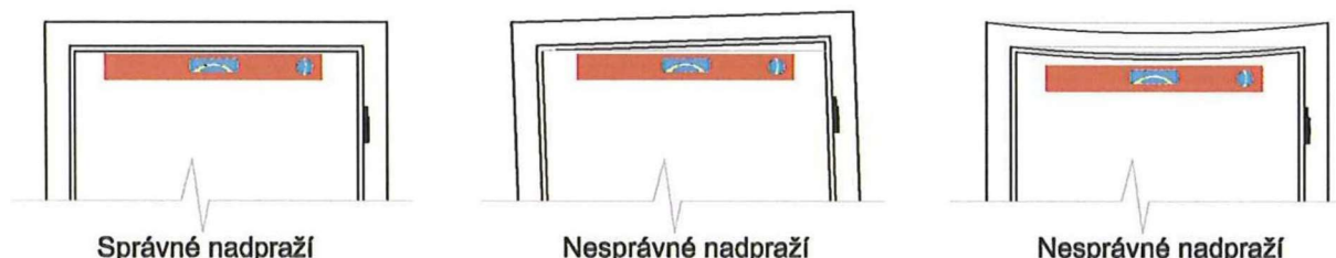
Obrázek 12. - Ukázka správného a nesprávného usazení zárubně.
