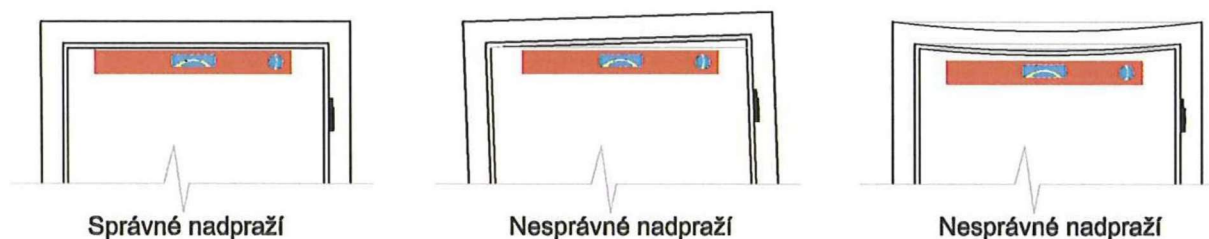
Obrázek 6. - Ukázka správného a nesprávného usazení zárubně.
