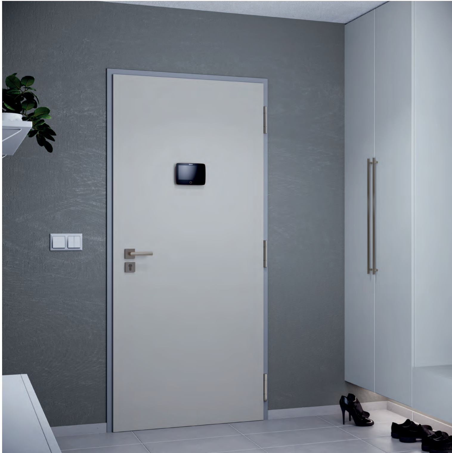
Sicht von der Wohnung: Modell ELEGANT 10 - HPL Antifinger hellgrau U708, Metallzarge SAP 865 - RAL 7035, Brandschutz 45 min, Sicherheitsklasse RC3, Schallschutz 37 dB und Klimaklasse III, Sicherheitsbeschlag M9, Digitaltürspion Eques VEIU Pro
