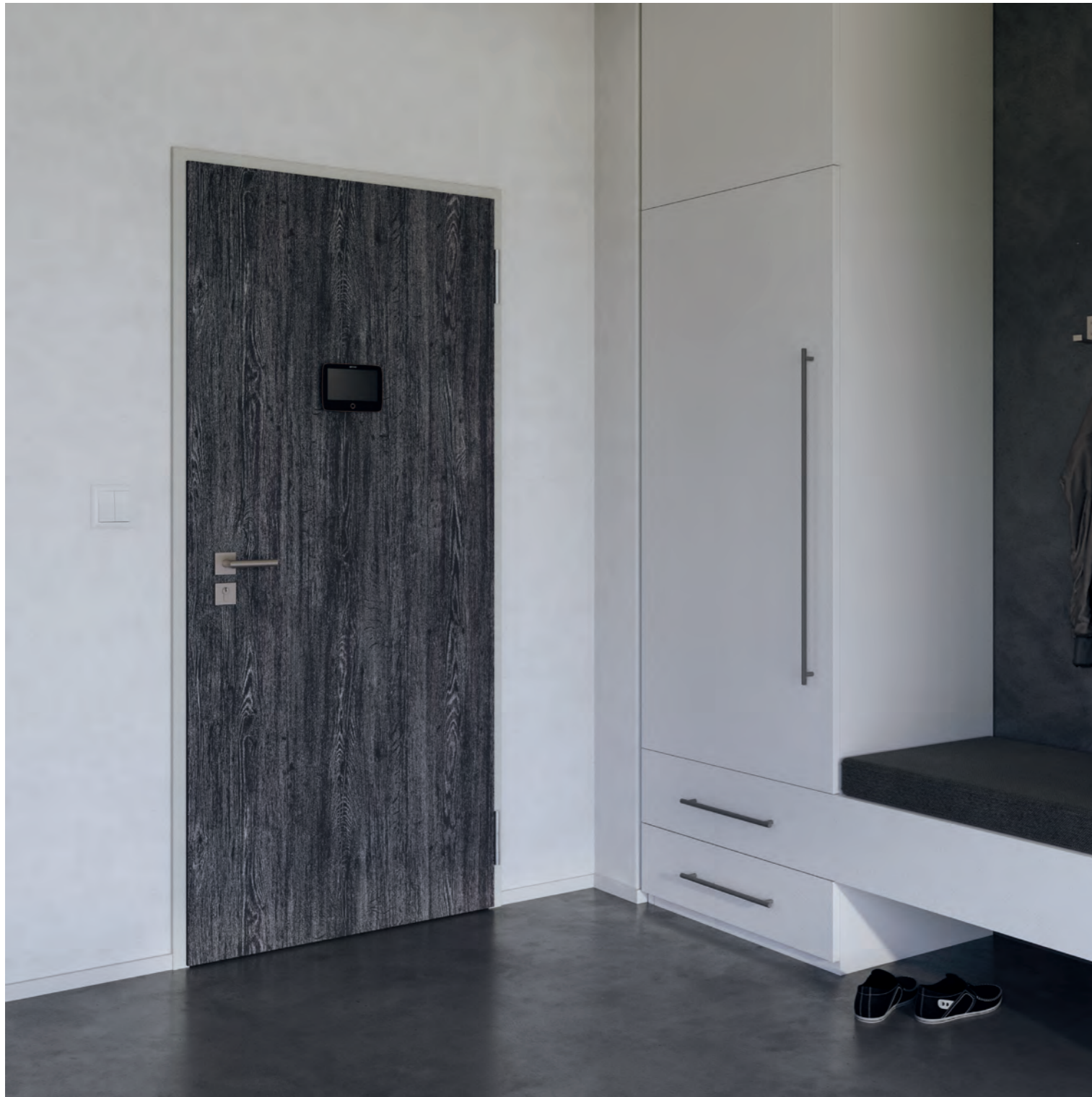
Sicht von der Wohnung: Ausführung ELEGANT 10 - HPL Feel Nature Halifax Eiche lasiert Schwarz, Metallzarge SAP 865 - RAL 7035, Feuerwiderstandsdauer 45 min, Sicherheitsklasse RC3, Schalldämmung 37 dB und Klimaklasse III, Sicherheitsbeschläge M9, digitaler Türspion Eques VEIU Pro
